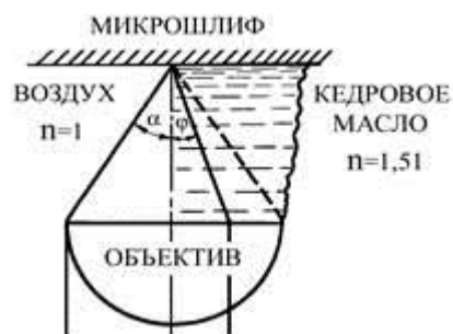
Рис.3 Влияние коэффициента преломления среды на ход световых лучей в сухом и иммерсионном объективе
